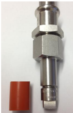
Foto: Detalle línea emisión inoxidable, y boquilla difusora.
